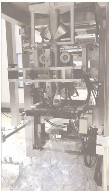
关键字：AM600、5轴全电子凸轮功能实现了下拉、竖封、横封、裁切的同步控制、高速低噪音运行。
