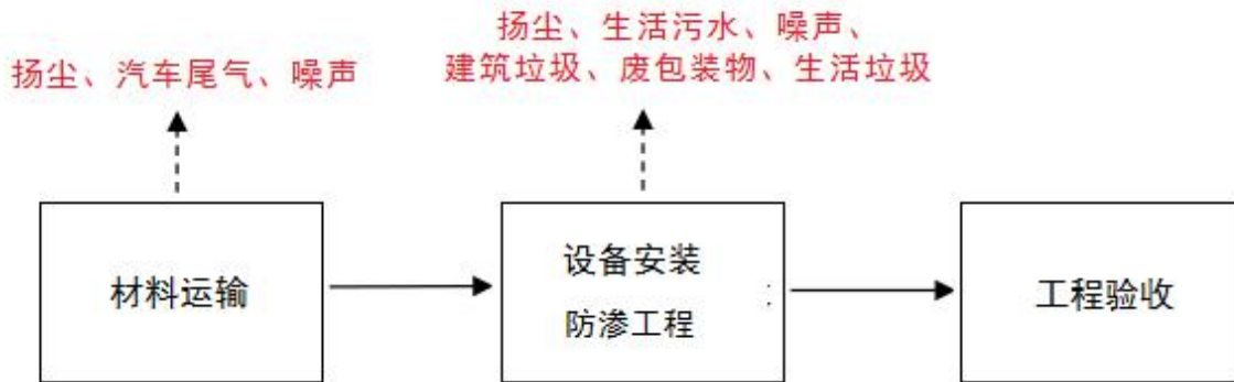
图 3.3-1 施工期工艺流程及产污节点图
