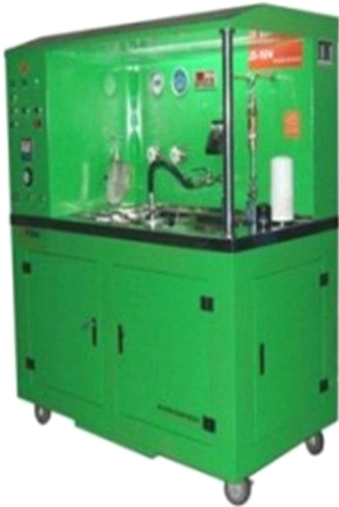
JDT-□ZK 机油滤多次通过试验台
