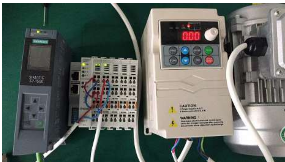
将 PLC 与适配器之间的网线断开，变频器自动停机，频率变为 0。
