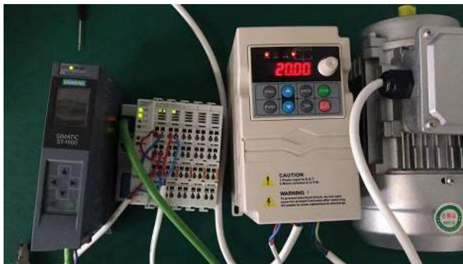
变频器正常工作在 20HZ
