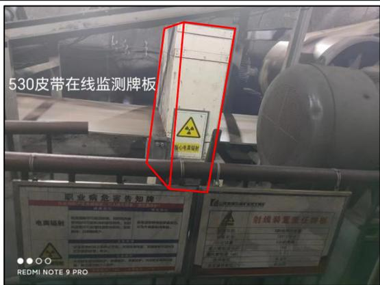
530 皮带无损检测装置控制区边界
