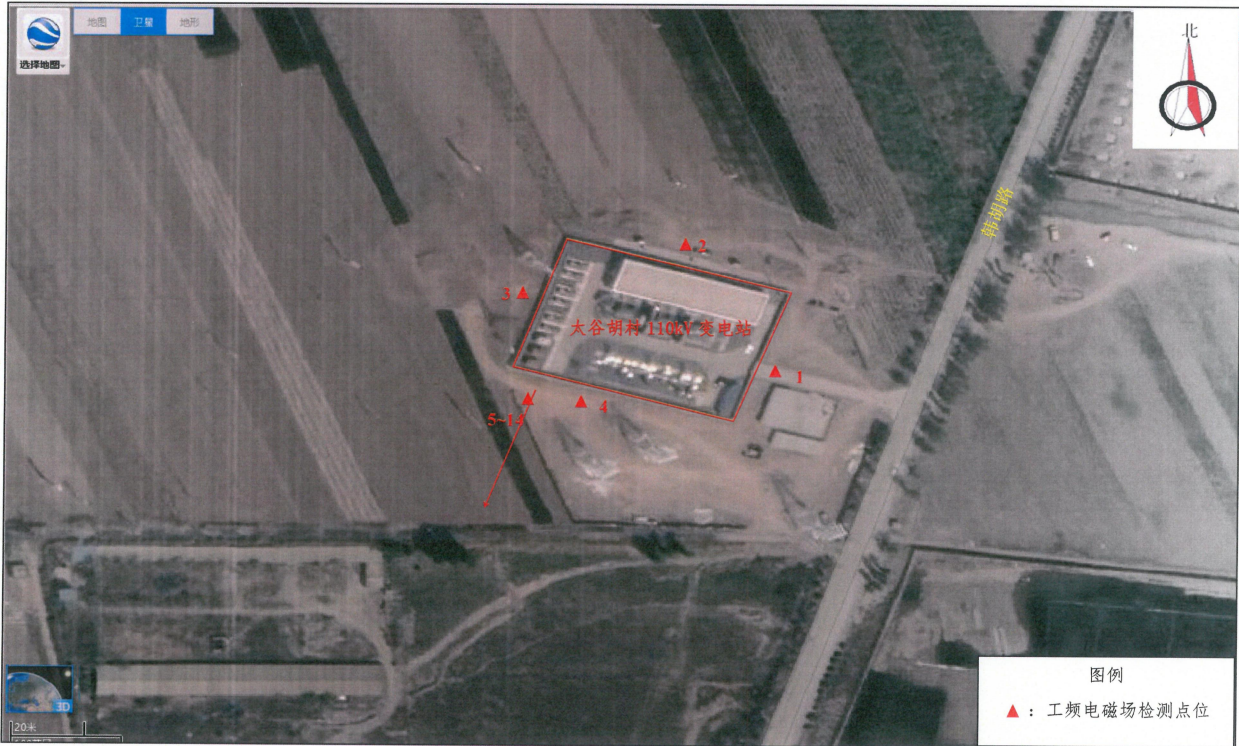
图 1 太谷胡村 110kV 变电站工频电磁场检测点位布置示意图
