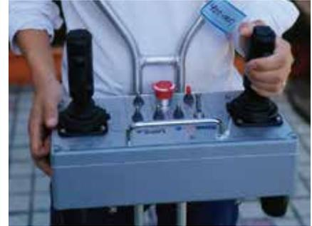
凯特龙AT16LHD和AT32LHD无线遥控器系统提供可靠，高效，便利的铲运机设备操作。这个无线遥控系统复制了铲运机驾驶室中手动遥控器的操作界面，允许操作人员站在更加安全的方位远程操控设备。
