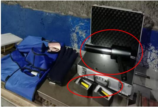
X-γ辐射检测仪、个人剂量报警仪
