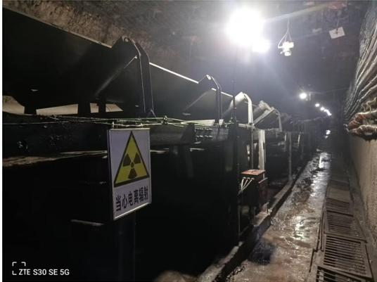
输送带无损检测装置、检修通道
