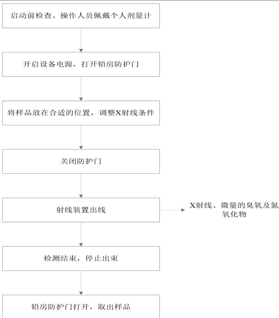
图 2-6 操作流程及产污环节图
