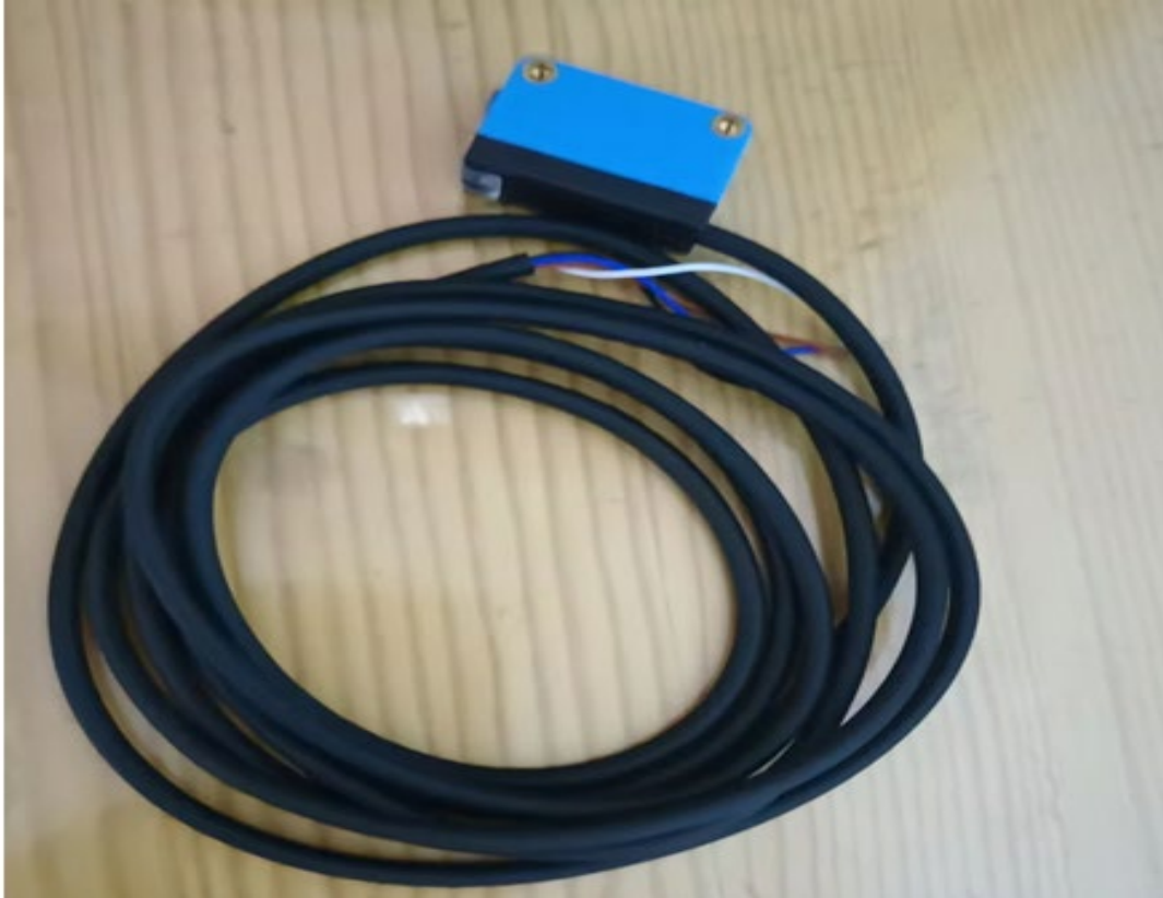
W 型镭射光传感器长 30 毫米宽 20 毫米厚 10 毫米，检测距离 550 毫米。检测精度高，质量可靠，重量轻。型号-KMWS55M-P
